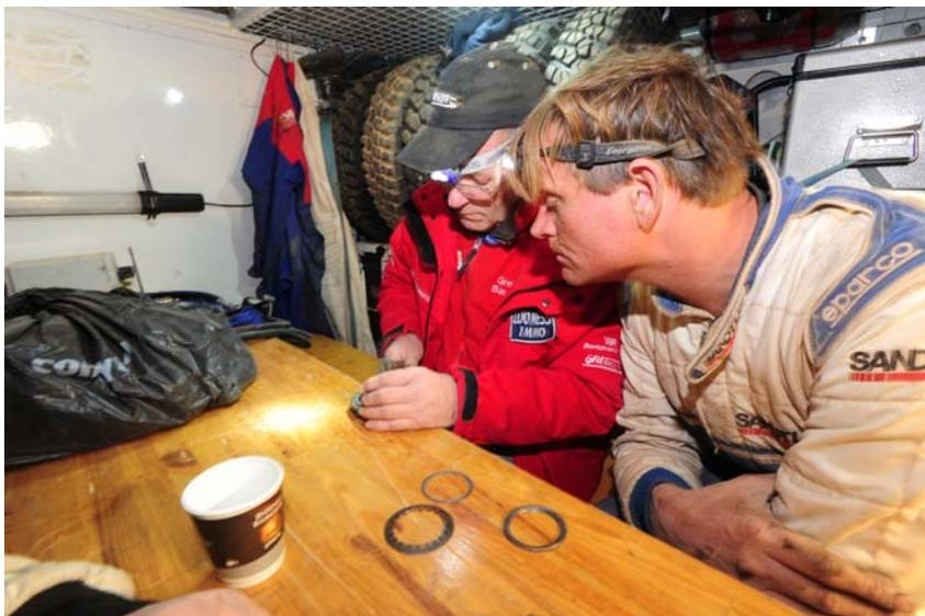
Mit Hilfe von Team Loomans wird das defekte Ausrücklager wieder gangbar gemacht
