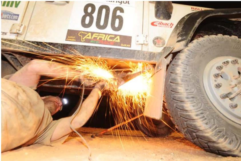
Ausschleifen des Rahmens um den Längslenker wieder zu montieren...
