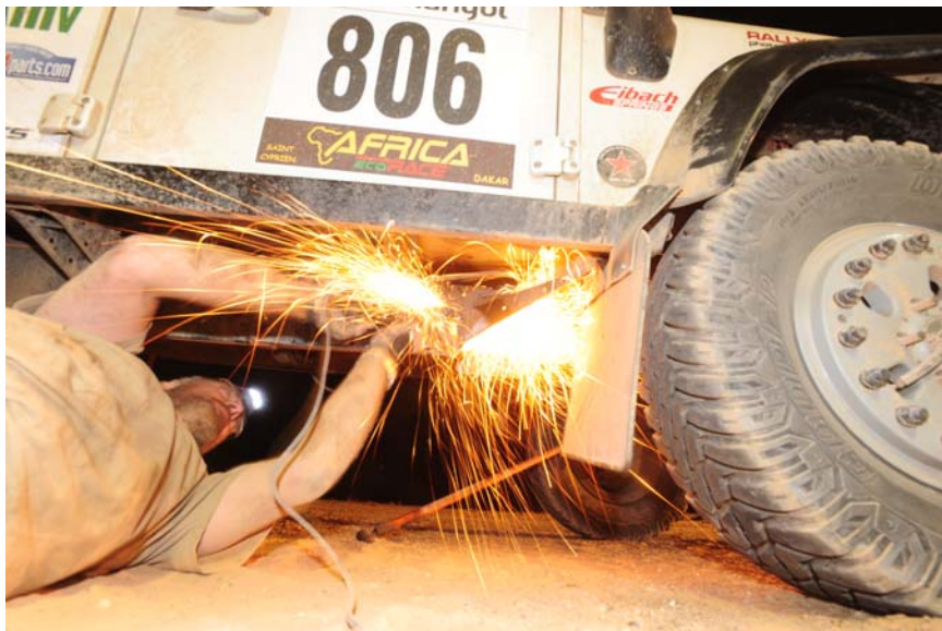
Ausschleifen des Rahmenhalters für den Längslenker
